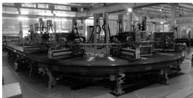
図8 導体絶縁中のITER TF 導体。絶縁装置は導体を徐々に持ち上げる部分、絶縁施工を行う部分、持ち上げた導体を徐々に下す部分に分けられる。これらの部分は連動してRP上を移動する。
